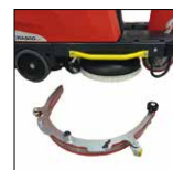
Saugdüse direkt hinter der Bürste.
