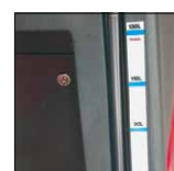
Skala für Frischwassertank
