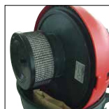
Motorkopf mit Hepafilter
