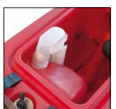
Effizienter Motorschutz dank Schwimmersystem
