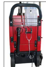
Rückseite mit Entleerschlauch und den Schaltern für die Chemie
