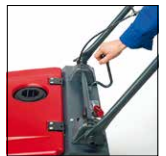
Hebel Seitenbesen absenken / anheben
